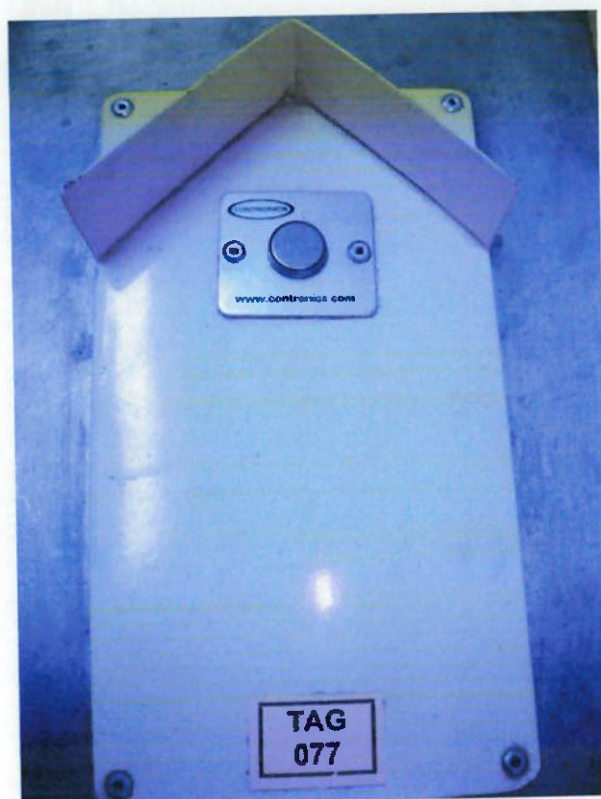
Figura 24 - Etiqueta de RFID instalada no painel de proteção
